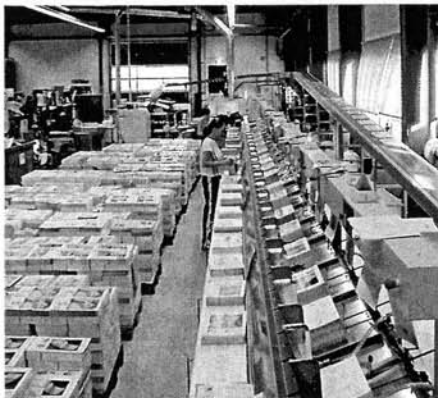
Die Wohlenberg-Zusammentragmaschine mit 24 Stationen ist auf Produktion mit vielen Bogenteilen ausgerichtet.
